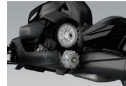
**AUTOMATIKGETRIEBE (STUFENLOSES GETRIEBE)**
