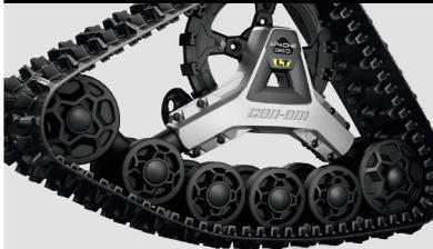
Der Stahl-Aluminium-Rahmen kombiniert die Widerstandskraft eines traditionellen Stahlchassis mit dem geringen Gewicht eines Aluminiumguss-Oberteils zu einer leichten jedoch robusten Raupe, die es mit jedem Element aufnehmen kann.
