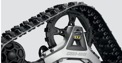
360 und 360 LT nutzen ein innenliegendes Antriebszahnrad, um die Zuverlässigkeit unter allen Bedingungen zu gewährleisten. Von Can-Am für Can-Am entwickelt ist es auf das Übersetzungsverhältnis Ihres Fahrzeugs hin optimiert.
