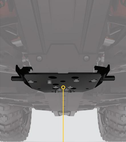
Flache Montageplatte hat **geringe Auswirkung auf Bodenfreiheit** und kann das ganze Jahr über montiert bleiben.
